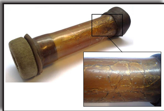
Fig. 5. Cylindre dégradé ©BnF / S. Bouvet
