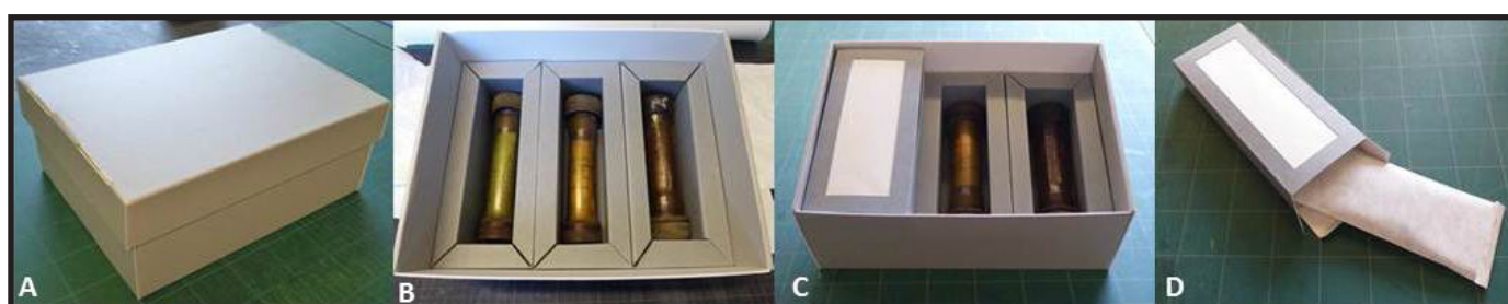
Fig.11. De gauche à droite : (a) la boîte de conditionnement avec son couvercle, (b) les 3 comblages, (c) et (d) une boîte pour le conditionnement de l'absorbant chimique dans son enveloppe.
